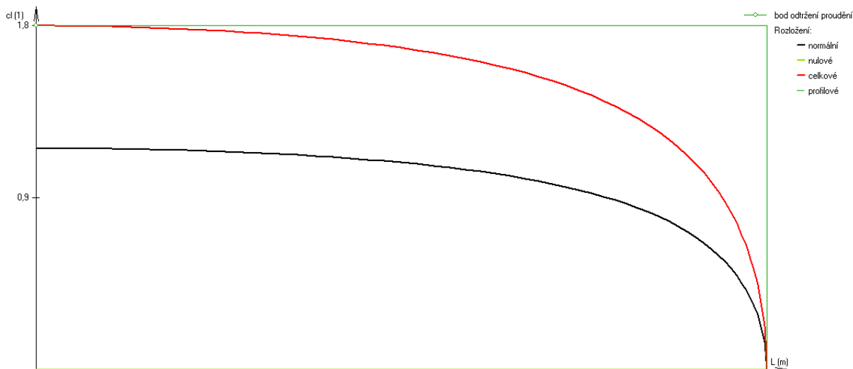
Obrázek 4.3 Rozložení součinitele vzlaku po rozpětí bez vzlakových klapkek
