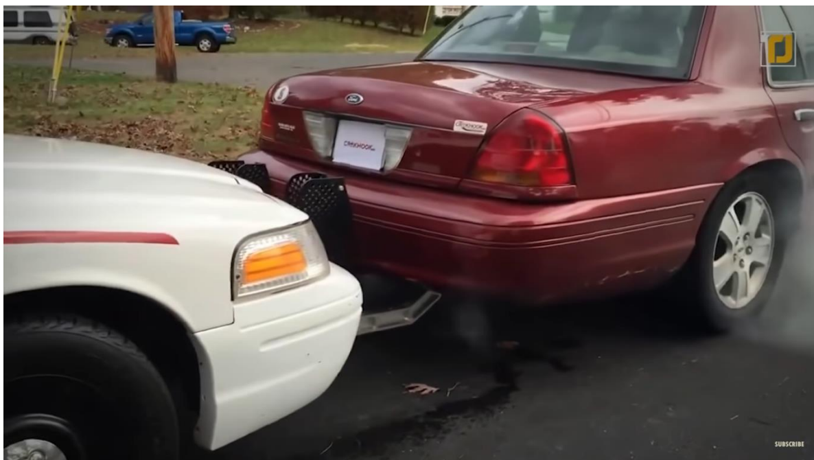
Příloha č. 7 Zastavovací háky upevněné na policejním voze 148
