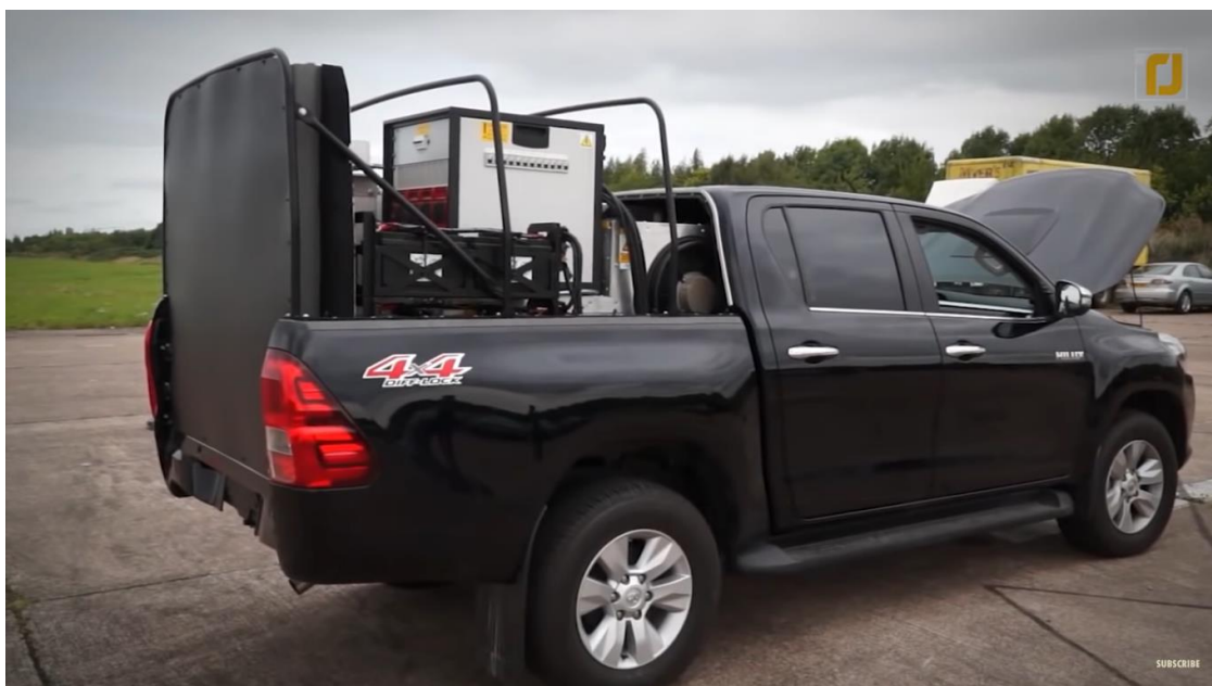
Příloha č. 8: Zařízení pro zastavení vozidla na principu radiové frekvence 149
