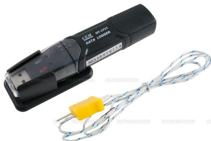
Obr.9 - Datalogger s externí sondou CEM DT-171T [14]
