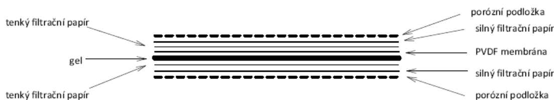
Obrázek 20: Uspořádání western blotu stylem Sandwich (převzato z Dobrušková 2012)
