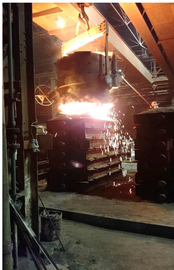
Obr. 18 Odlévání oceli do formy
