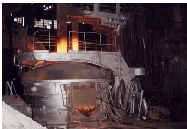
Obr. 2 Pec slévárenského typu [7]
