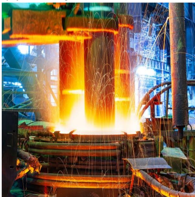
Obr. 11 Tavení pomocí elektrického oblouku [23]
