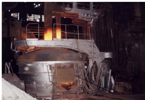
Obr. 2 Pec slévárenského typu [7]
