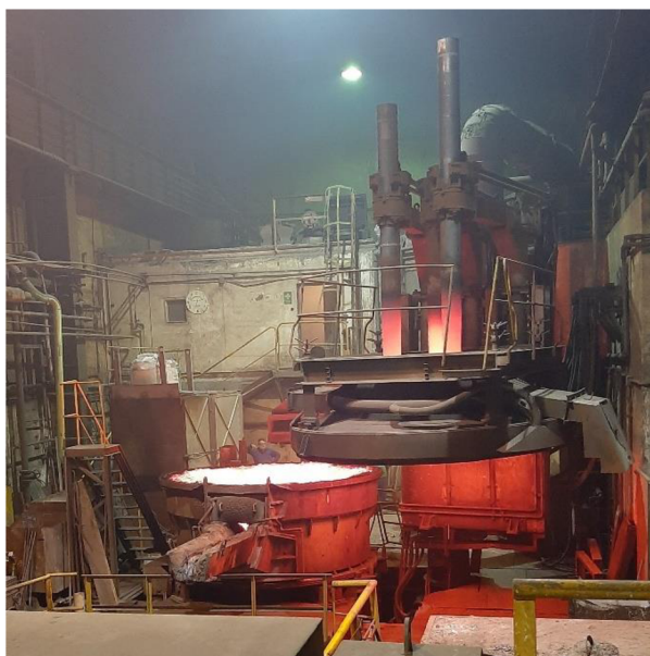
Obr. 12 Odklápění víka pece
