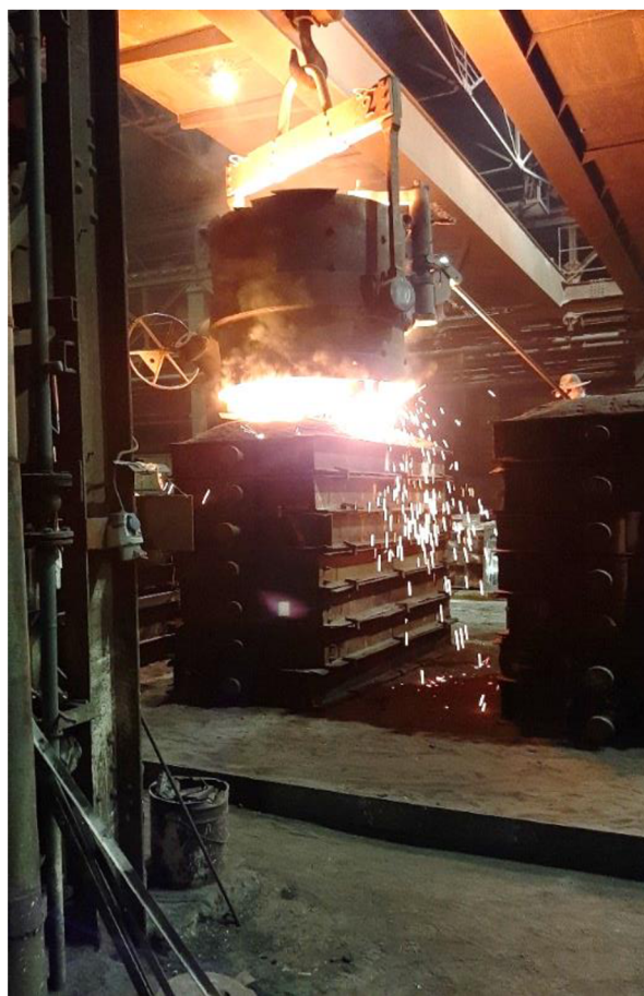
Obr. 18 Odlévání oceli do formy
