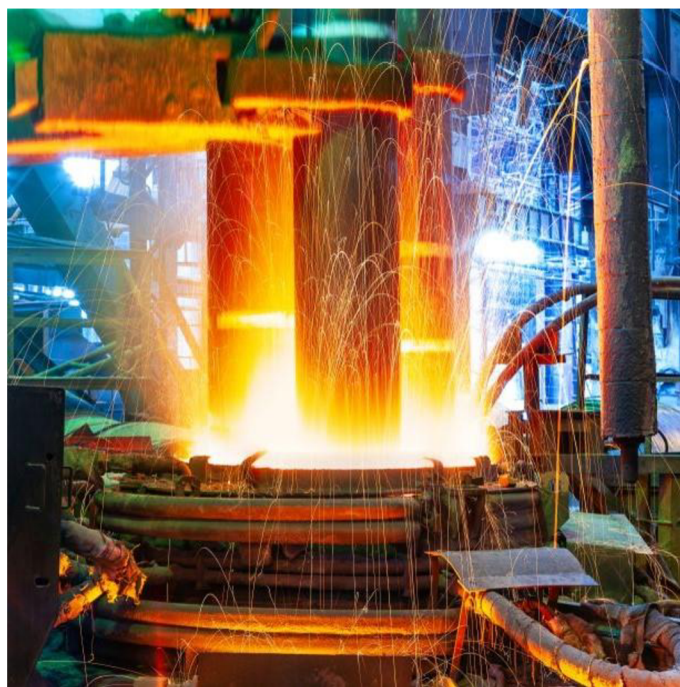
Obr. 11 Tavení pomocí elektrického oblouku [23]
