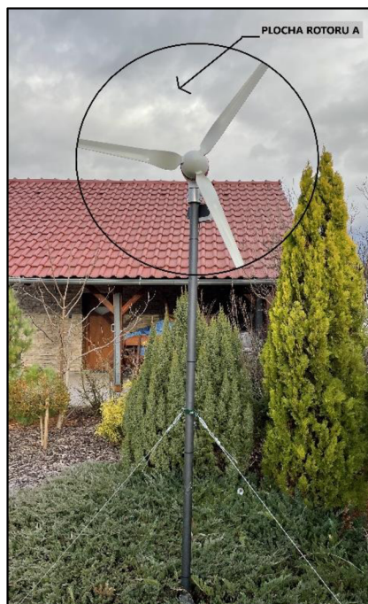
Obrázek 26 Malá větrná elektrárna
