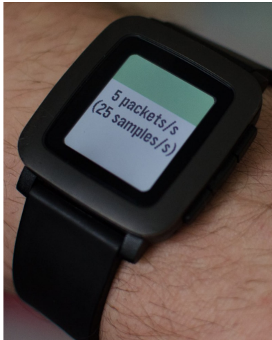
Obr. 4.16: Zber dát z akcelerometra.
