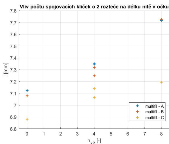
Obr. 29: Graf vlivu počtu spojovacích kliček o 2 rozteče na délku nitě v očku
