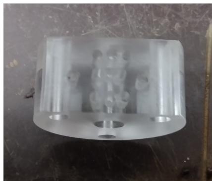
Obr. 2.5: Finální stav střední části výbojové komory
