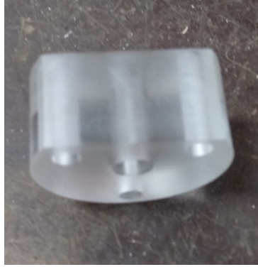
Obr. 2.3: Výbojová komora - se zakrácenou stranou na upevnění krycího sklíčka pohled ze strany na výbojovou komoru.
