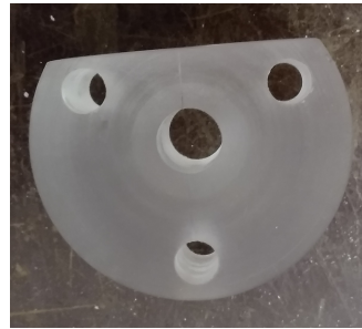
Obr. 2.2: Výbojová komora - se zakrácenou stranou na upevnění krycího sklíčka.
