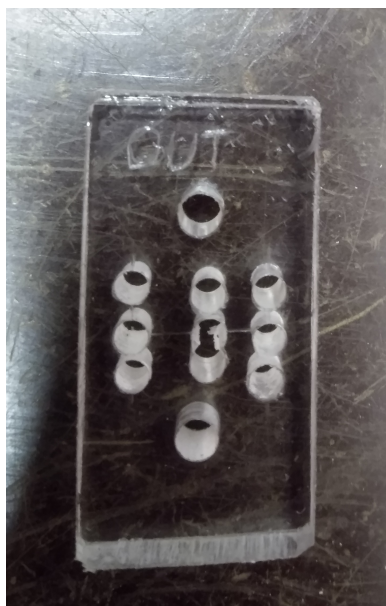
Obr. 2.4: Držák na upevnění optických vláken.
