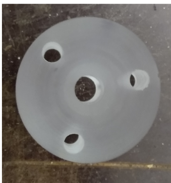
Obr. 2.1: Výbojová komora - původní část komory po vytvoření děr na propojení všech částí.
