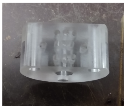
Obr. 2.5: Finální stav střední části výbojové komory
