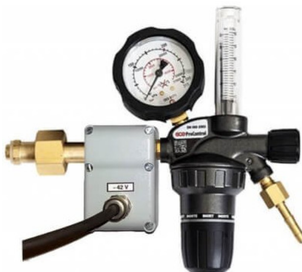
Obrázek 1.3: Vyhříváný redukční ventil pro tlakovou láhev s CO_2 používaný u svařování MIG MAG [51]. V nepříznivých podmínkách může ventil zamrznout. Následně ventilem neproudí ochranná atmosféra, což se nepříznivě projeví na kvalitě svaru.
