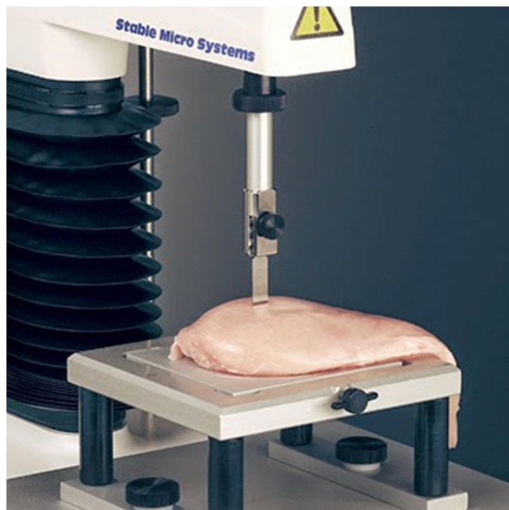
Obrázek 6 – Střihá zkouška pomocí Meullenet-Owensovy čepel (TEXTURE ANALYSIS PROFESSIONALS BLOG, 2014)
