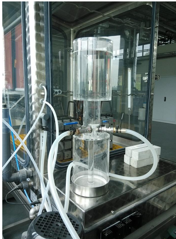
Obrázek 23 - Měřicí nádoba naplněná dole plynem a nahoře parafínem
