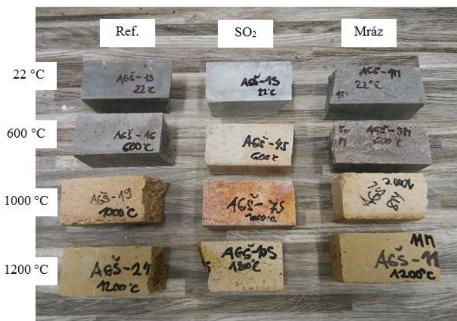
Obrázek 41 - Receptura ALŠ ve stáří 90 dní po vystavení nepříznivým vlivům vč. teplotní expozice
