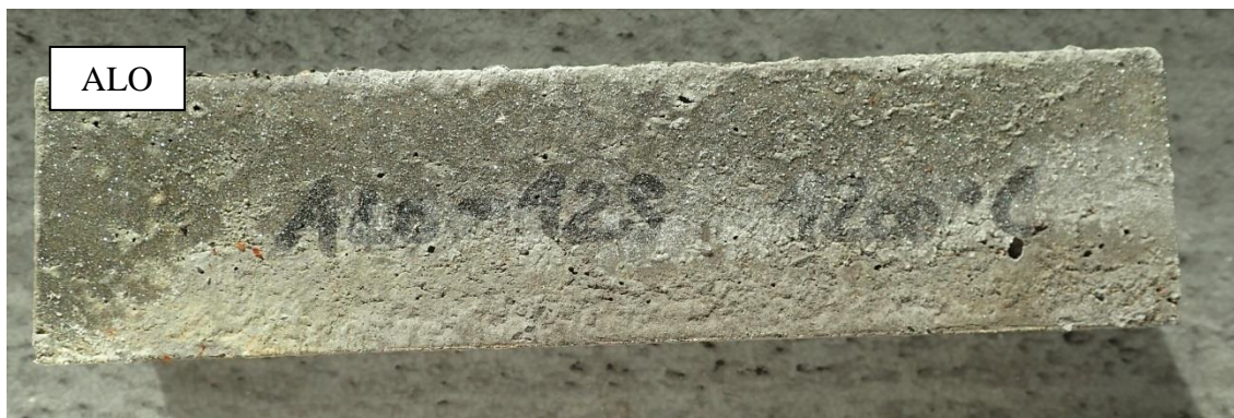
Obrázek 38 - Výkvěty vytvořené při působení agresivního plynu SO_2 a vlhkosti
