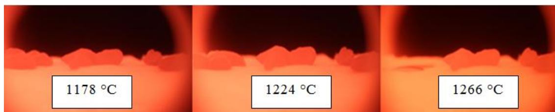
Obrázek 27 - Teplotní expozice Liaporu (uprostřed) při daných teplotách [61]
