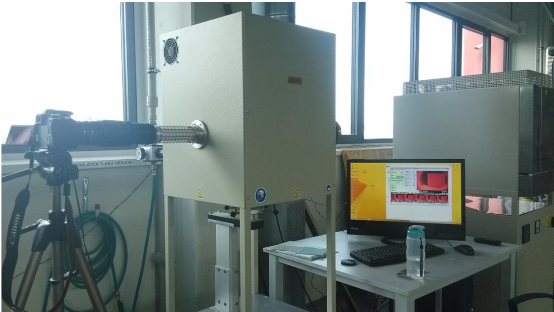
Obrázek 16 - Pozorovací pec propojená s výpočetní technikou a digitálním fotoaparátem pro monitorování hmot za zvyšujících se teplot (Centrum AdMaS)
