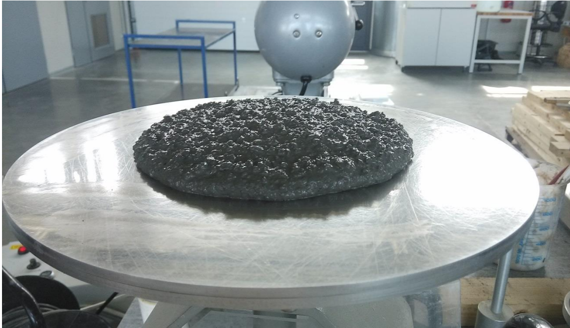
Obrázek 18 – Průběh testování konzistence (rozlití) malty
