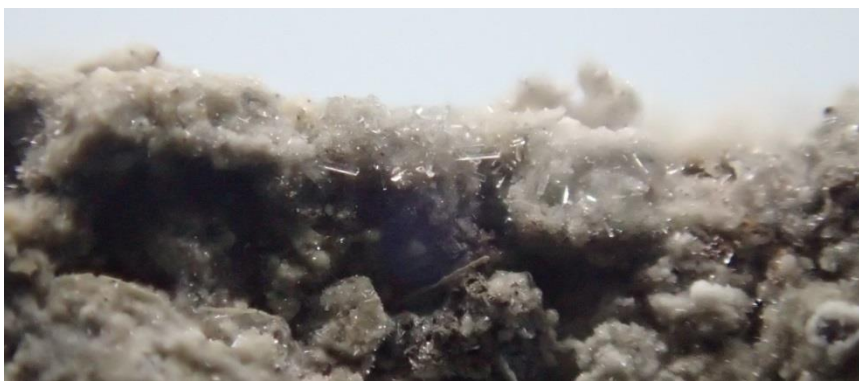
Obrázek 36 - Krystaly produktů sulfatace
