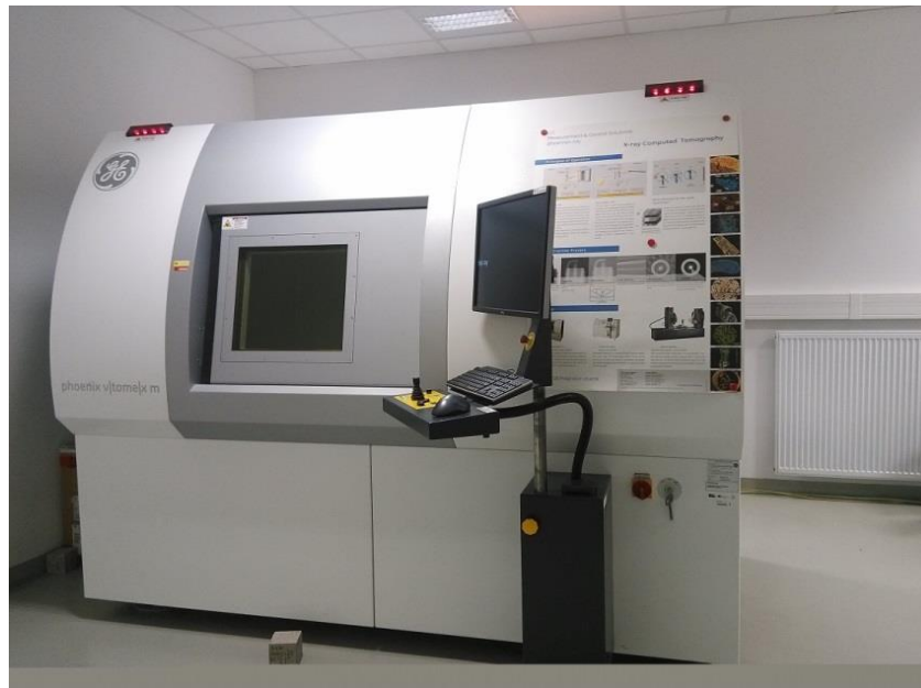
Obrázek 25 – Tomograf phoenix v|tome|x m300 od výrobce GE Sensing & Inspection Technologies (Centrum AdMaS)
