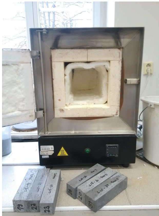
Obrázek 21 - Elektrická pec se zkušebními tělesy před teplotním zatěžováním
