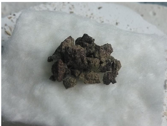
Obrázek 29 - Vzorek agloporitu frakce 1-4 mm vyjmutý z pozorovací pece (po expozici cca 1280 °C)
