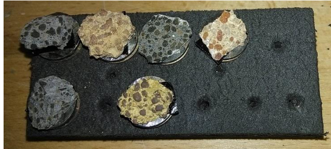
Obrázek 47 - Vzorky připravené na analýzu v elektronovém mikroskopu
