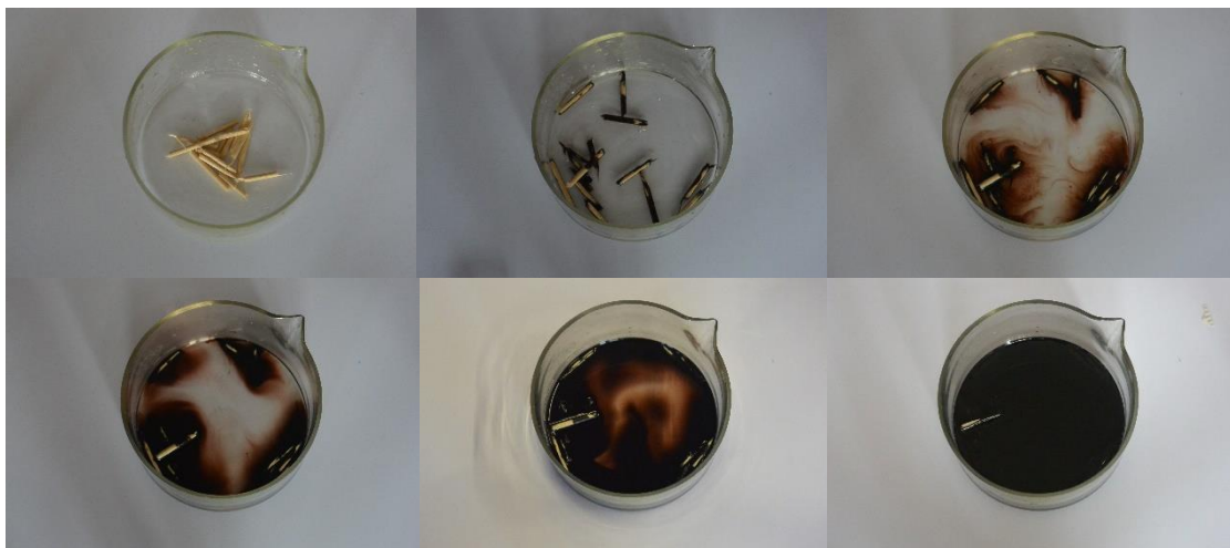
Obrázek 33: Časosběrné snímky z dehydratačního účinku H_2SO_4 (foto učitelé školy)
