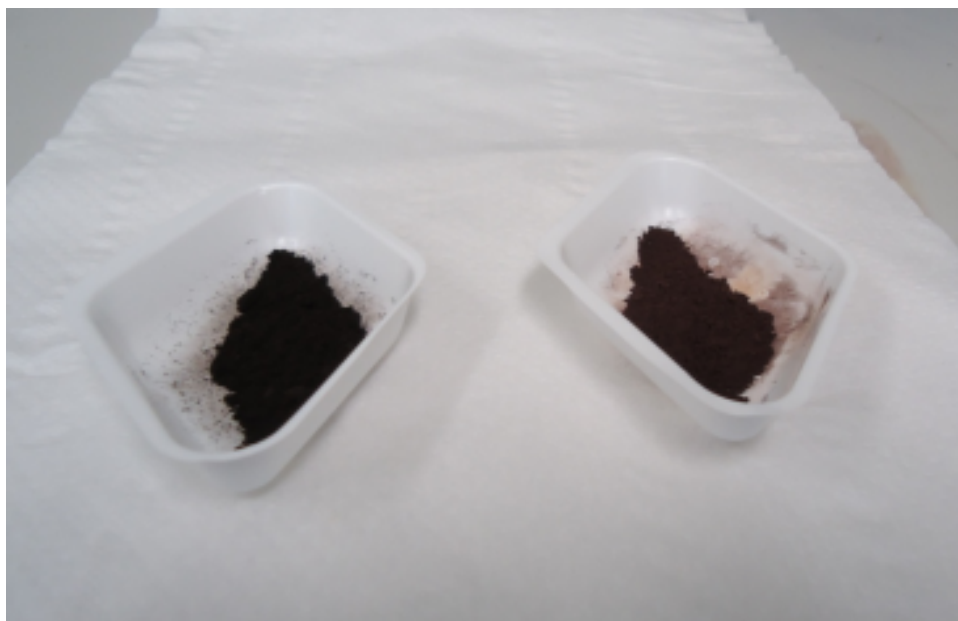
Obr. 13: Nanočástice oxidů železa v práškové formě (vlevo: magnetit, vpravo: maghemit)
