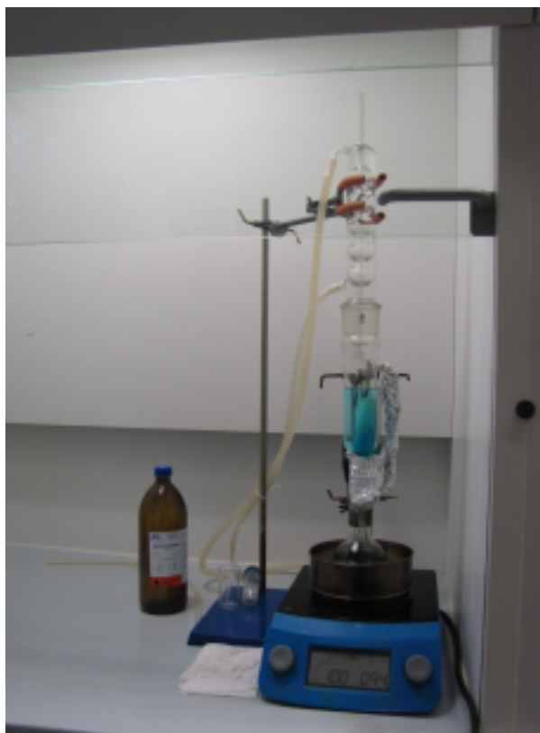
Obr. 14: Soxhletova aparatura pro vymytí nenavázaného Cu-ftalocyaninového barviva
