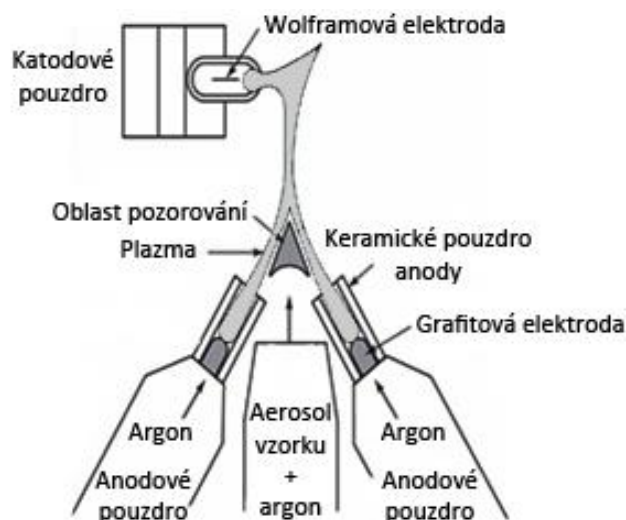
Obr. 2.6 Tříelektrodová stejnosměrná plazma [19]
