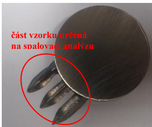
Obr. 4.11 Vzorek na spalovací analýzu
