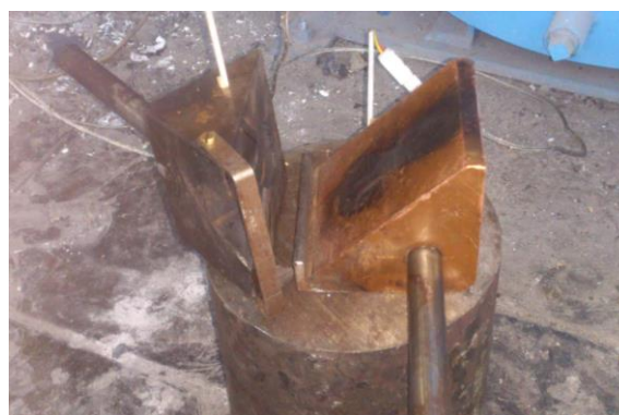
Obr. 4.4 Rozložená kokila během ochlazování
