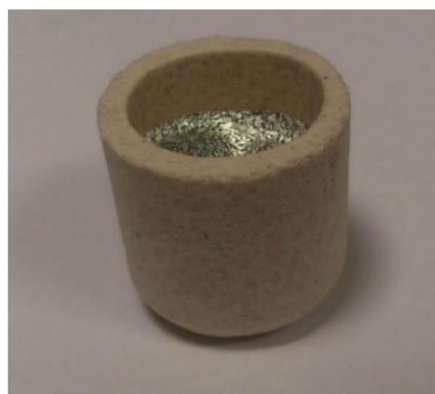
Obr. 4.12 Kelímek se vzorkem a wolframem připravený na spalovací analýzu
