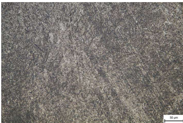
Obr. 42 Mikrostruktura ZM, zvětšení 400x, leptadlo Villela.
