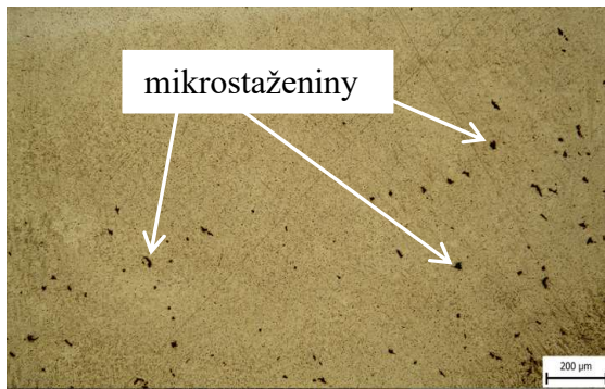
Obr. 51 Mikrostruktura FN, vzorek B, zvětšení 200x, leptadlo Beraha.
