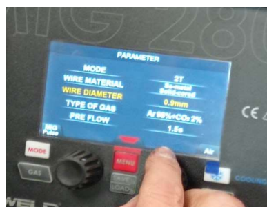
Obr. 16 Nastavení parametrů na svářecím zdroji.
