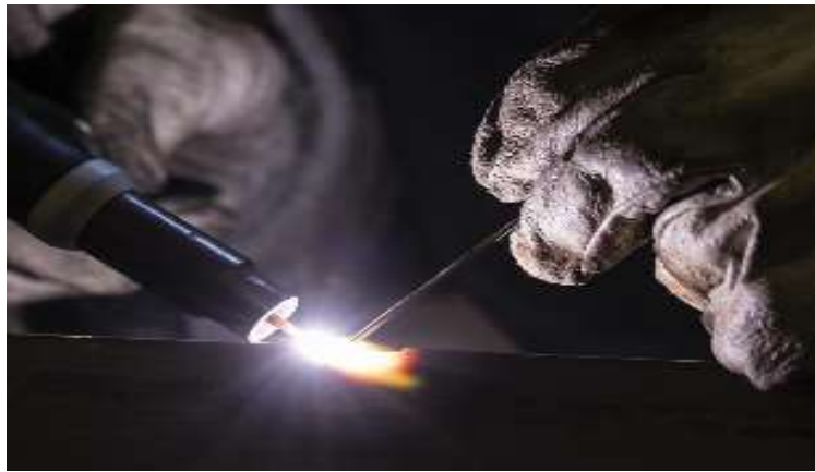
Obr. 6 Renovace metodou TIG/WIG [13].
