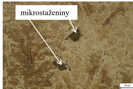
Obr. 48 struktura FN, vzorek A, zvětšení 1000x, leptadlo Beraha.
