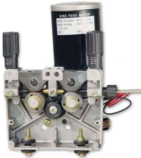
Obr. 13 Čtyřkladkový podavač drátu [35].
