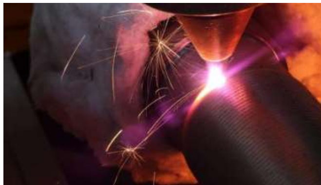
Obr. 8 Renovace pomocí laseru [19].
