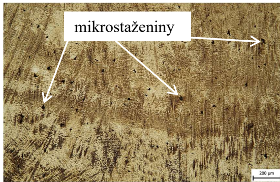
Obr. 47 struktura FN, vzorek A, zvětšení 200x, leptadlo Beraha.
