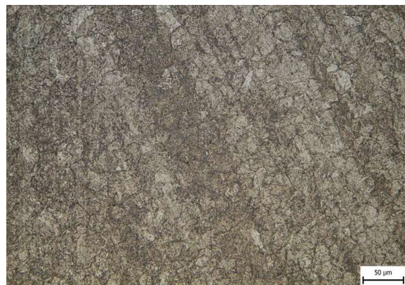
Obr. 43 Mikrostruktura TOO, zvětšení 400x, leptadlo Villela.
