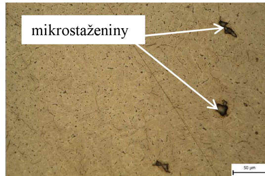
Obr. 52 Mikrostruktura FN, vzorek B, zvětšení 500x, leptadlo Beraha.
