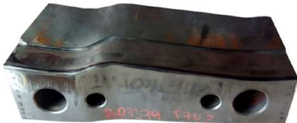
Obr. 2 Část zápustky před navařením.
