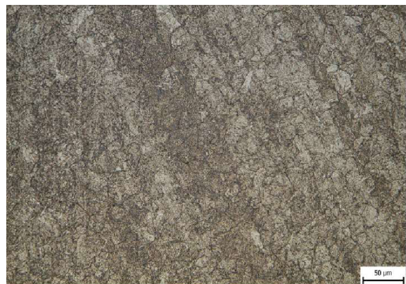
Obr. 43 Mikrostruktura TOO, zvětšení 400x, leptadlo Villela.
