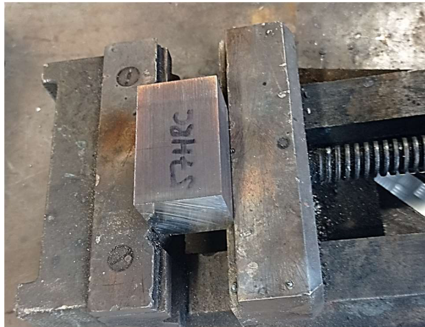
Obr. 22 Přípravený hranol pro navaření plochy.
