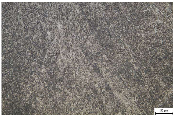
Obr. 42 Mikrostruktura ZM, zvětšení 400x, leptadlo Villela.
