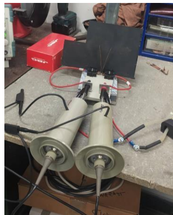
Obr. 14 Zapojenie vysokonapät'ových sond
