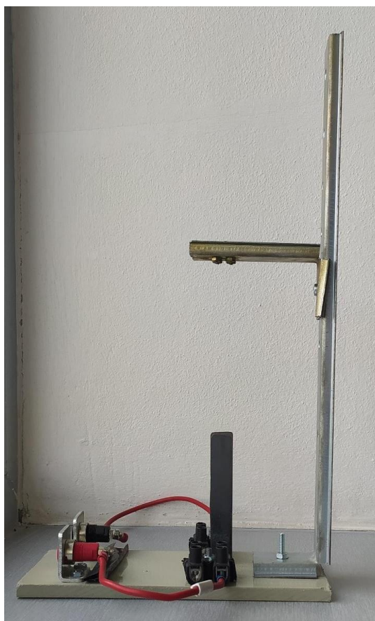
Obr. 7 Stojan na meranie a analýzu plazmy
