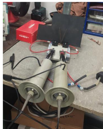
Obr. 14 Zapojenie vysokonapäťových sond
