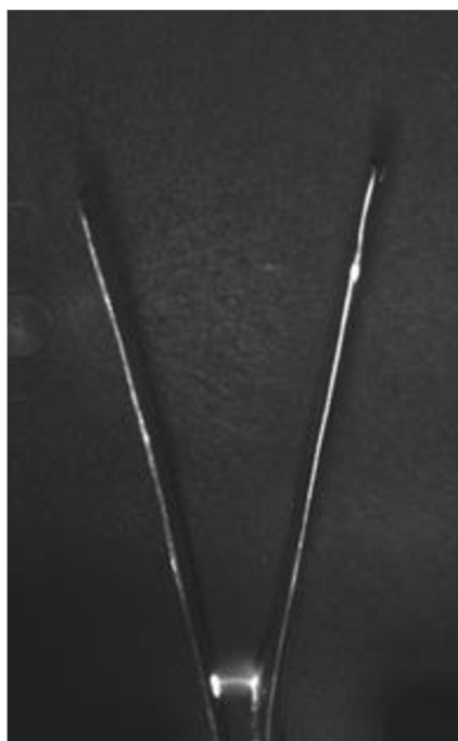
Obr. 20 Oblúk pri najmenšej vzdialenosti medzi elektródami
