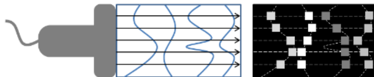
Obr. 1.12: Zobrazení B módu, odrazy vytváření dvourozměrného obraz. Jas každého bodu odpovídá velikosti odrazu. Poloha každého pixelu v obraze odpovídá místu odrazu paprsku v měřené oblasti, převzato z [4]
