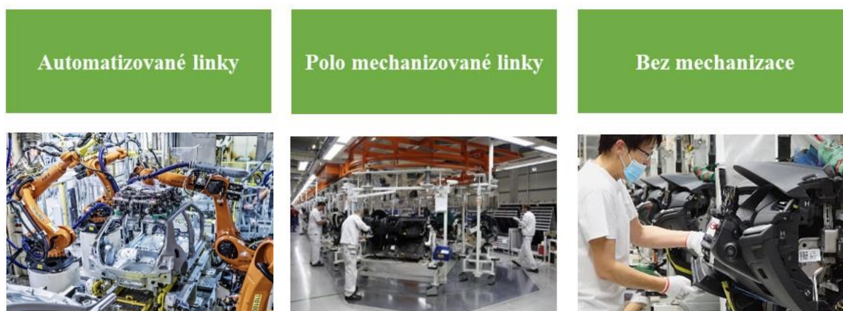
Obrázek 2 – Typy montážních linek
