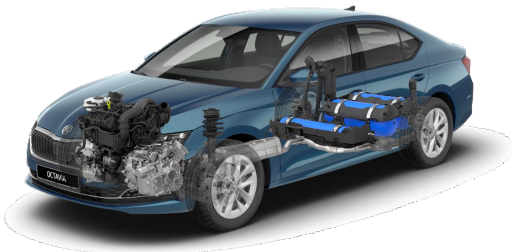
Obrázek 25 - OCTAVIA CNG - s uloženými nádrži na CNG pod zadními sedadly a v části zavazadlového prostoru
