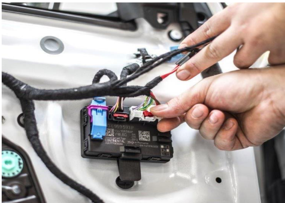
Obrázek 29 - Zapojení řídicí jednotky dveří
