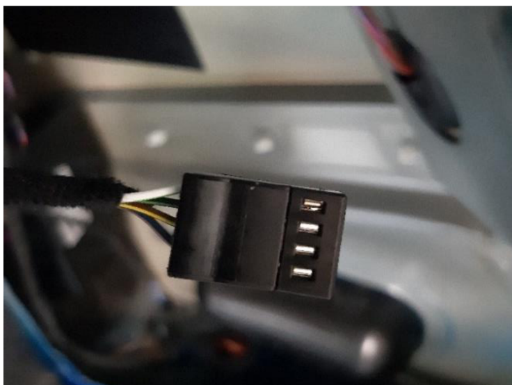
Obrázek 16 - Svorkovnice v zavazadlovém prostoru - tažné
