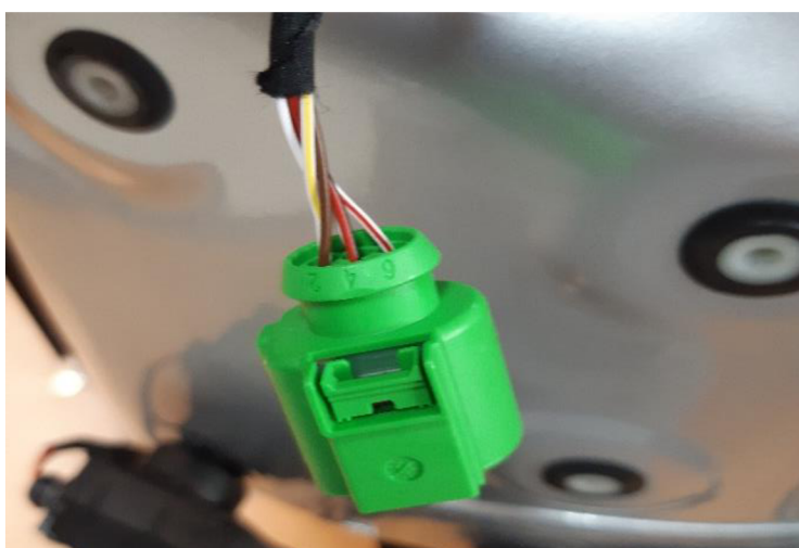
Obrázek 17 - Svorkovnice v zadní části vozu - skupinové světlo
