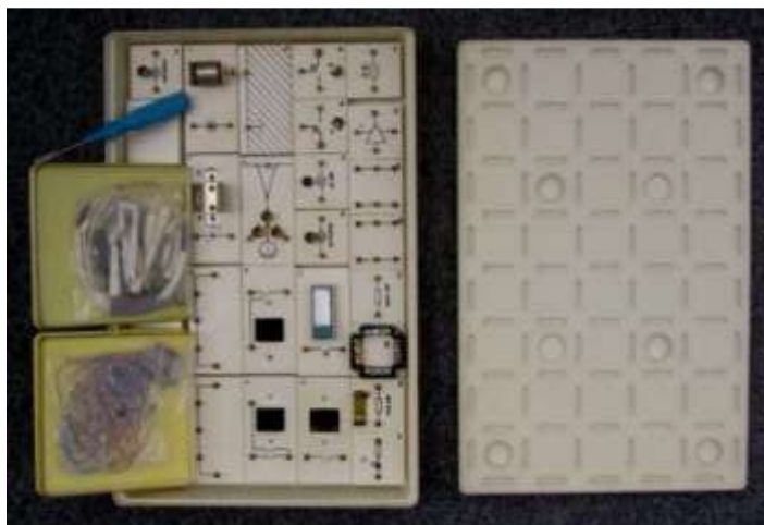
Obrázek 2- Elektrotechnická stavebnice Z 3/III (Honzíková a kol., 2016).
