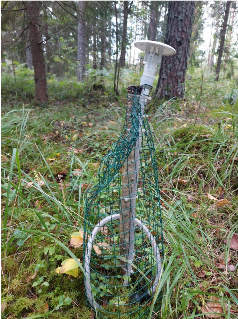
Obrázek č 7. Fotografie mikroklimatického čidla TMS-4 opatřeného ochranným pletivem proti okusu zvířat.
