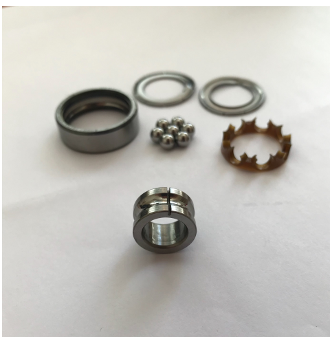
Obrázek 5.2: Ložisko s uměle vytvořenou vadou.
