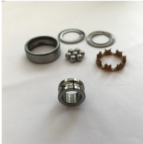
Obrázek 5.2: Ložisko s uměle vytvořenou vadou.
