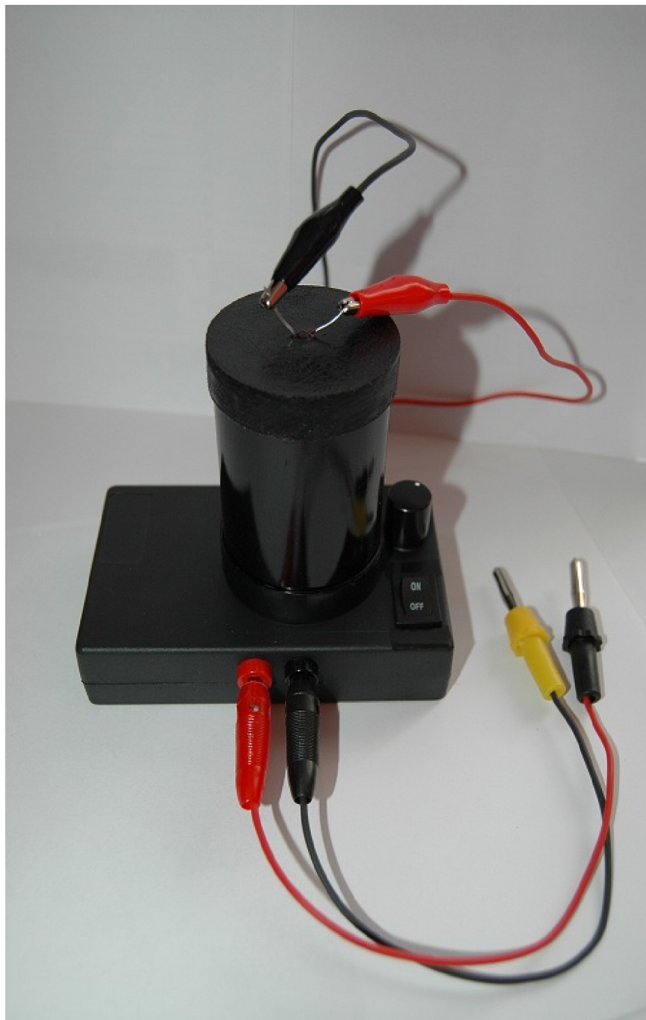
Obrázek 16: Zařízení pro měření absorpční hrany. Nezapojené vývody jsou určeny pro připojení ampérmetru.
