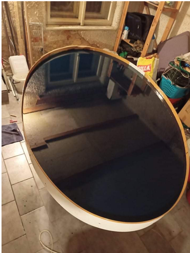
Pohled na 1. Instalaci, proces výroby– překližka, epoxid, 2x1,25m
