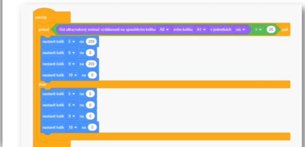
Obrázek 84: Ovládání motorů ultrazvukem
