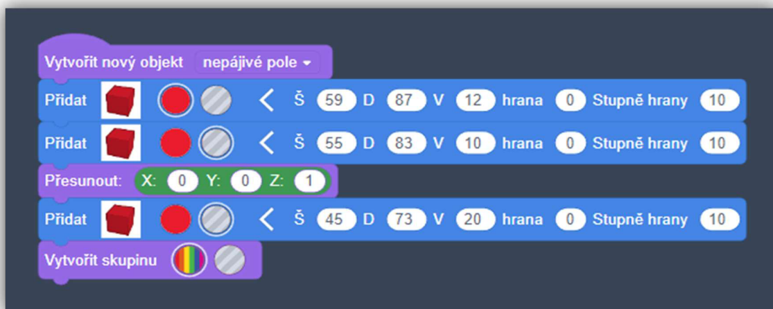
Obrázek 60: blokový program pro výrobu krabičky na nepájívé pole
