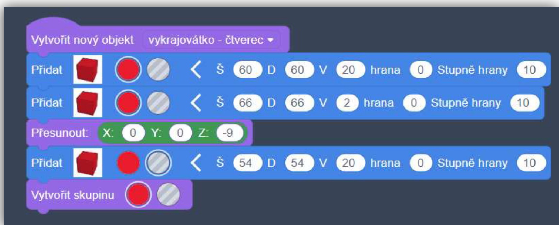
Obrázek 42: blokový kód pro výrobu vykrajovátka (Zdroj: vlastní zpracování)
