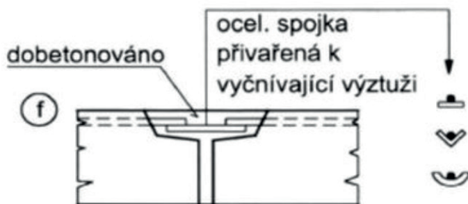
Obrázek 51: Osazení průvlaků ve vnitřní části haly
