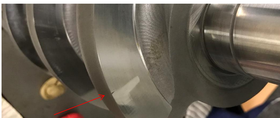
Obr. 6.13. Opotřebení axiální dvojvačky po životnostních testech karuselu II .
