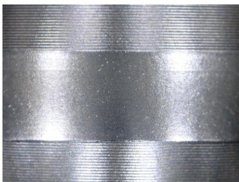
Obr. 6.6. Povlak BALINIT TRITRON na nové netestované rolně. Nakonec tento povlak kvůli špatným vlastnostem nebyl použit. Vydával obrovský hluk při testování.
