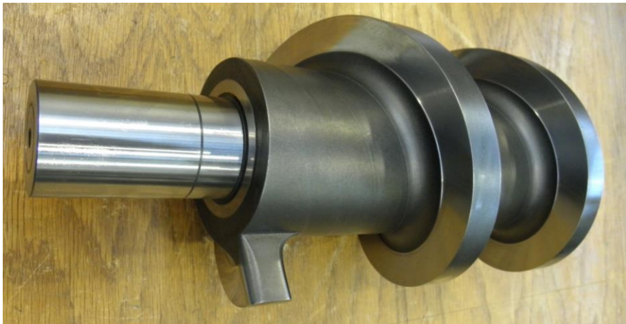
Obr. 3.4. Hotová axiální vačka po broušení.
