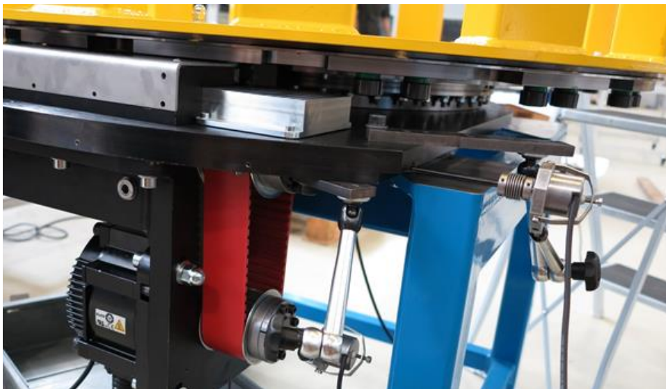
Obr. 4.2. Inkrementální snímače umístěné na výstupní hřídeli motoru a hřídeli vačky.
