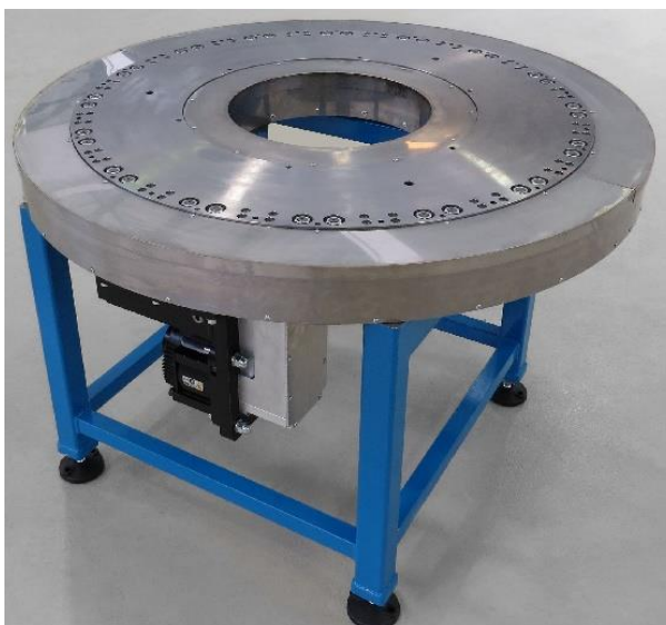
Obr. 6.2. Karusel I . Hotový, zakrytovaný finální výrobek na pomocném rámu.
