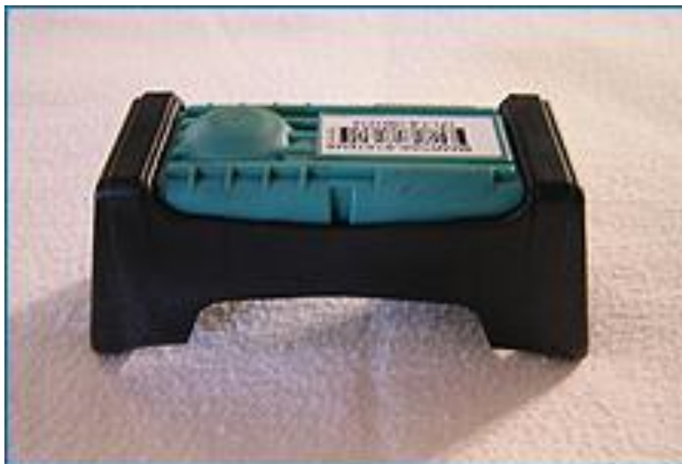
Obr. 9. Standardní snímač tlaku, který se montuje na ráfek. [13]
