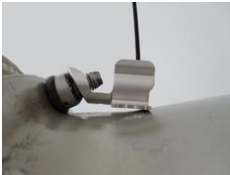
Obr. 5. Bezdrátový a bezbateriový snímač od firmy Stack využívající patentovanou technologii SAW. [3]
