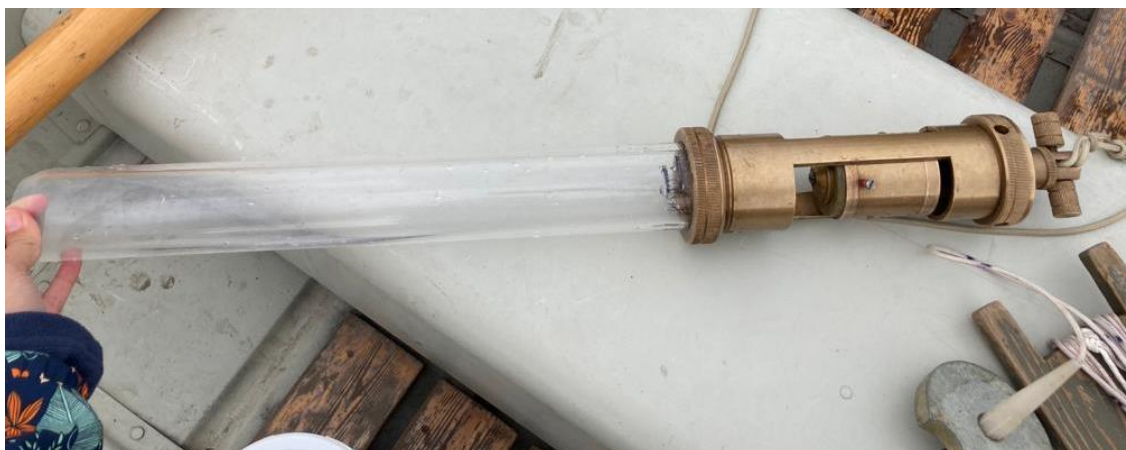
Obr. 4.2.2 Gravitační jádrový sběrač vzorků sedimentu, zkráceně nazývaný corer, je zavěšený na laně a zavírací mechanismus se spouští trhnutím (zdroj: autor)
