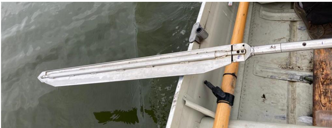
Obr. 4.2.1 Odběrák pro odběr vzorků píchanou sondou, tzv. kopí o délce listu 1,0 m nasazeným na nastavitelné tyči do délky 7 m; firma Eijkelkamp (zdroj: autor)
