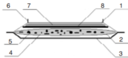
Obr. 8 Současný výrobek (1-vrchní vrstva, 2-absorpční jádro v hedvábném papíru, 3-spodní vrstva, 4-celulóza, 5-SAP, 6-hydrofobní bariéry, 7-akviziční vrstva, 8-distribuční vrstva) [19]
