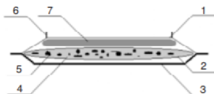
Obr. 7 Ultratenký výrobek (1-vrchní vrstva, 2-absorpční jádro v hedvábném papíru, 3-spodní vrstva, 4-celulóza, 5-SAP, 6-hydrofobní bariéry, 7-akviziční distribuční vrstva) [19]
