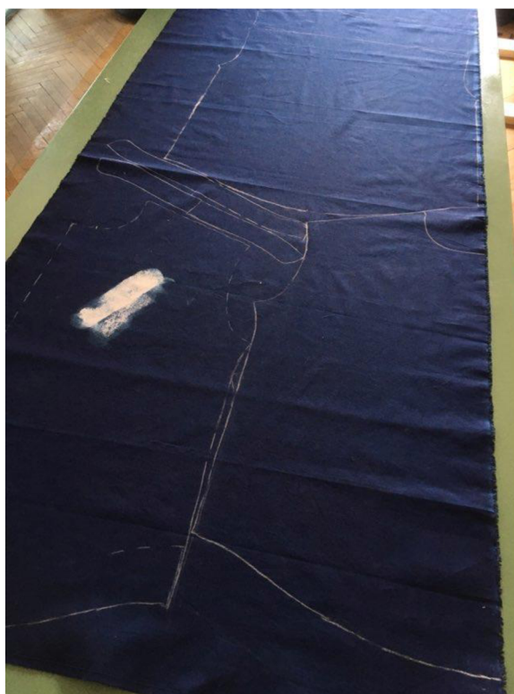
Obr. 20: Střihový plán na dezénu
