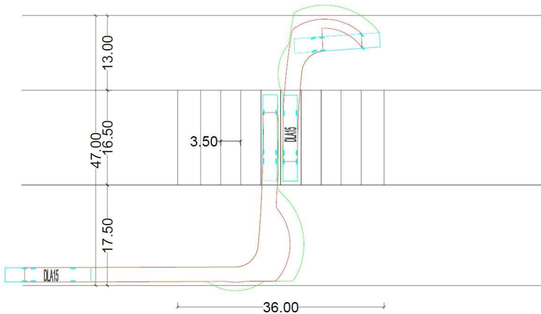
Obrázek 30: Vlečná křivka, kolmé řazení, rozměry stání po optimalizaci (autobusy)
