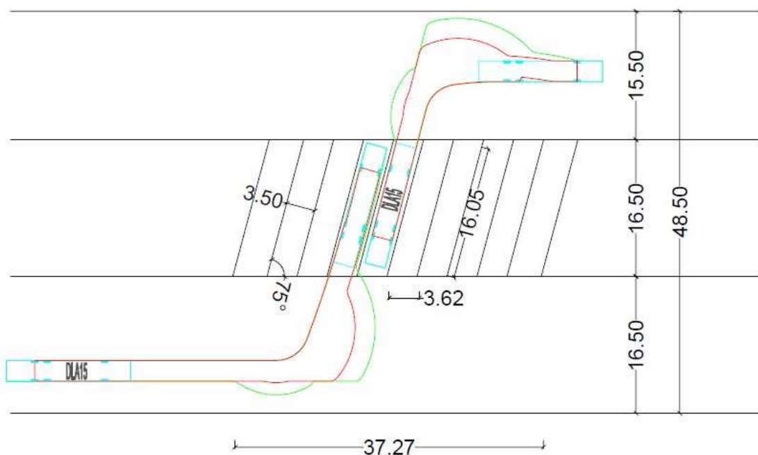
Obrázek 22: Vlečná křivka, šikmé řazení 75°, rozměry stání ČSN 73 6056 (autobusy)
