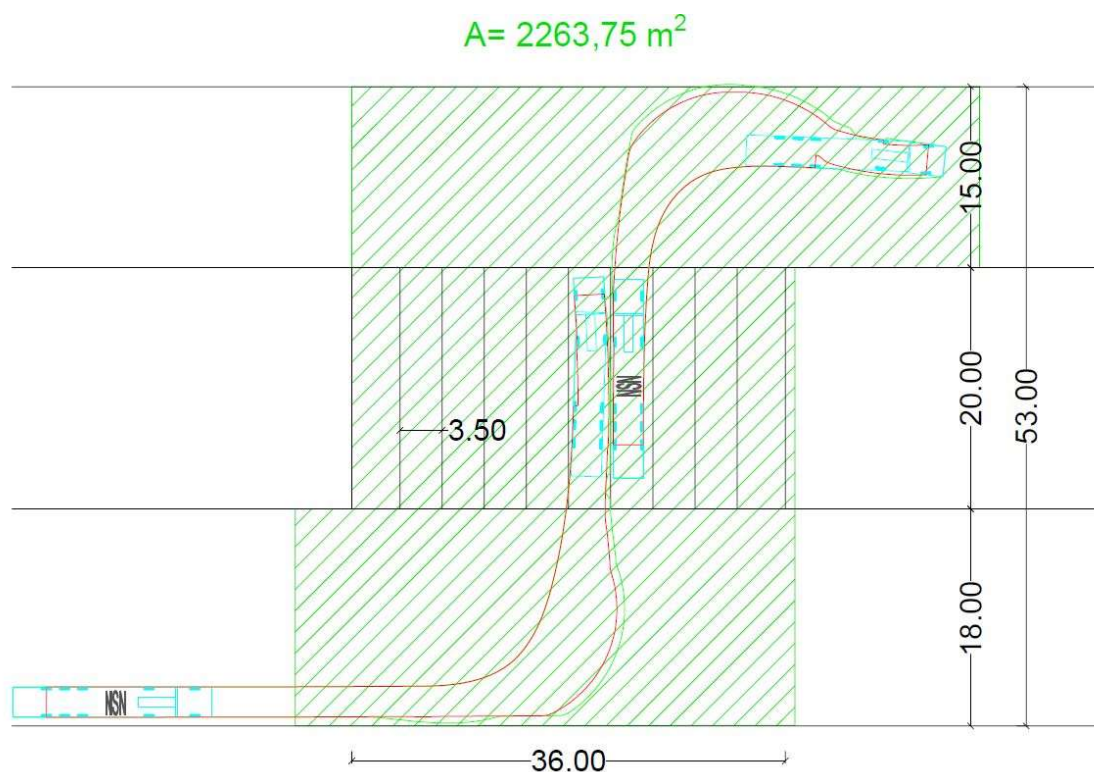
Obrázek 50: Plocha 10 stání s přilehlou komunikací, kolmé stání, rozměry stání ČSN 73 6056 (nákladní automobily)
