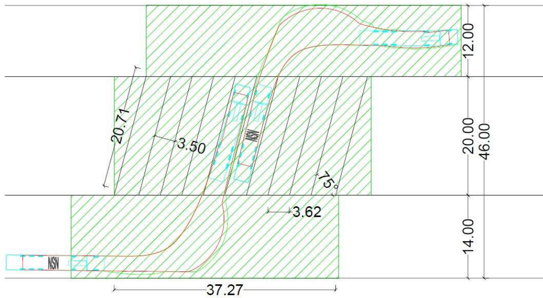
Obrázek 51: Plocha 10 stání s přilehlou komunikací, šikmé řazení 75°, rozměry stání ČSN 73 6056 (nákladní automobily)
