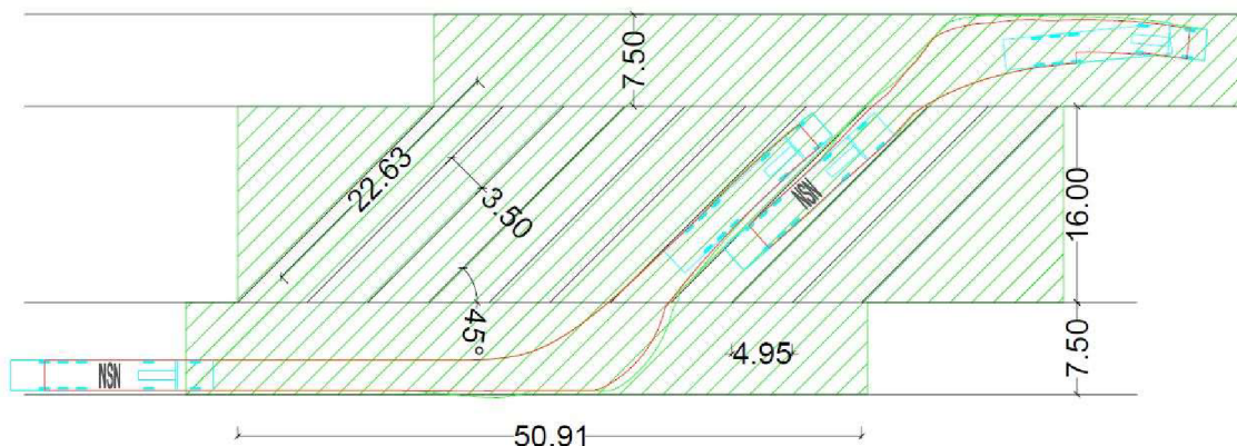
Obrázek 53: Plocha 10 stání s přílehlou komunikací, šikmé řazení 45°, rozměry stání ČSN 73 6056 (nákladní automobily)
