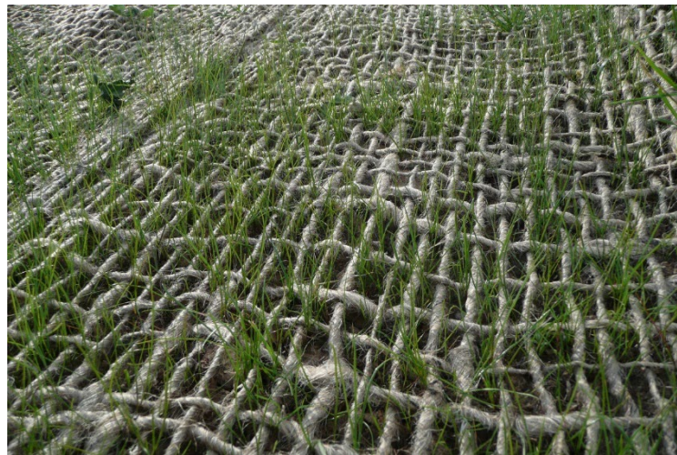
Obrázek 3 – Detail jutové geotextílie o plošné hmotnosti 500 g/m 2 po jednom roce položení (JUTA, 2022)
