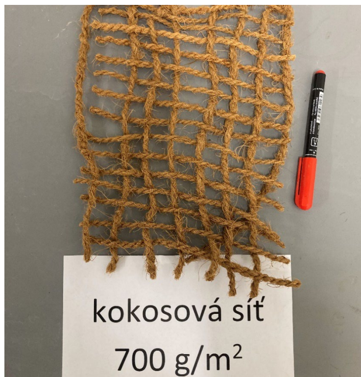
Obrázek 8 – Vzorek kokosové geotextílie o plošné hmotnosti 700 g/m 2 (Hlava, 2023)
