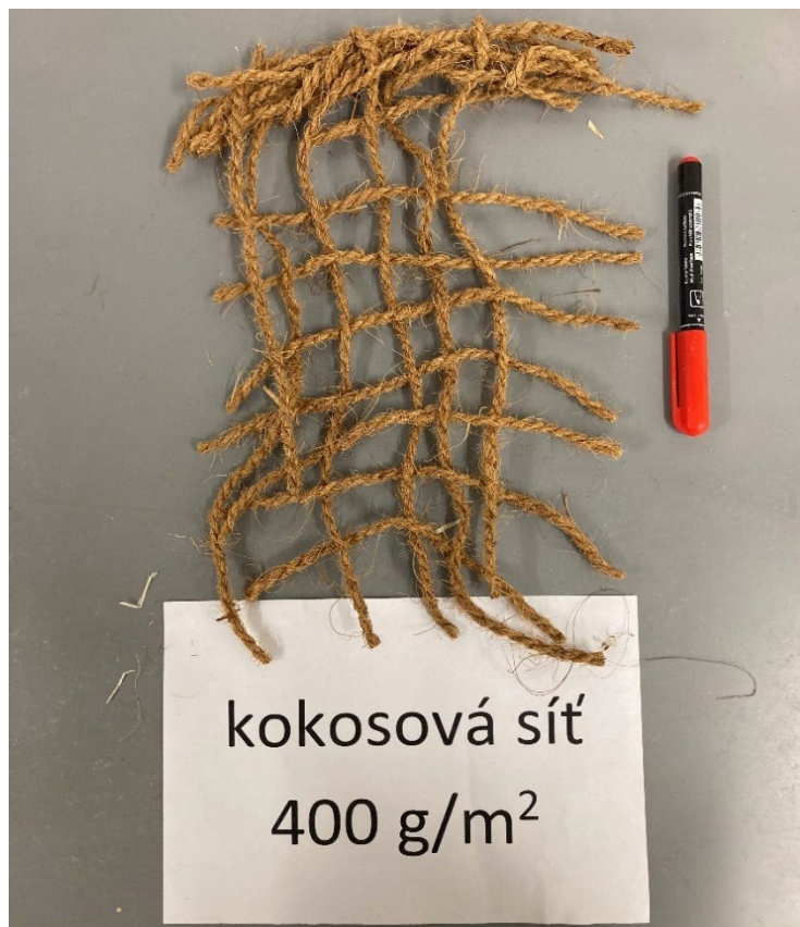
Obrázek 7 – Vzorek kokosové geotextílie o plošné hmotnosti 400 g/m 2 (Hlava, 2023)
