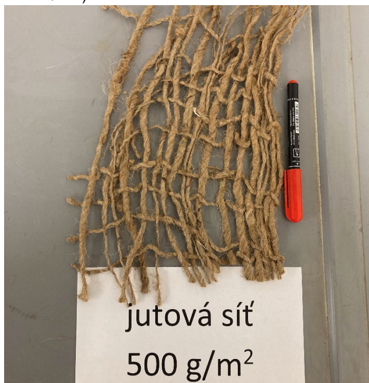
Obrázek 2 – Vzorek jutové geotextílie o plošné hmotnosti 500 g/m 2 (Hlava, 2023)
