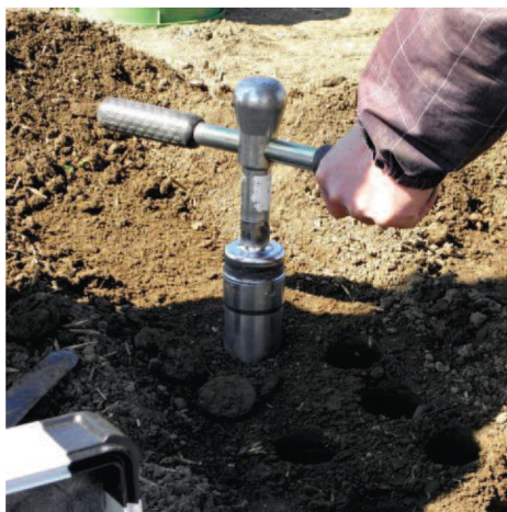
Obr. 2.32 Odběr půdních vzorků pomocí Kopeckého válečků v hloubce 0 – 10 cm (vlastní foto)
