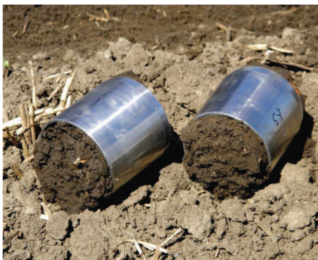
Obr. 28 Ukázka odebraných neporušených půdních vzorků před odříznutím přesahující zeminy (vlastní foto)
