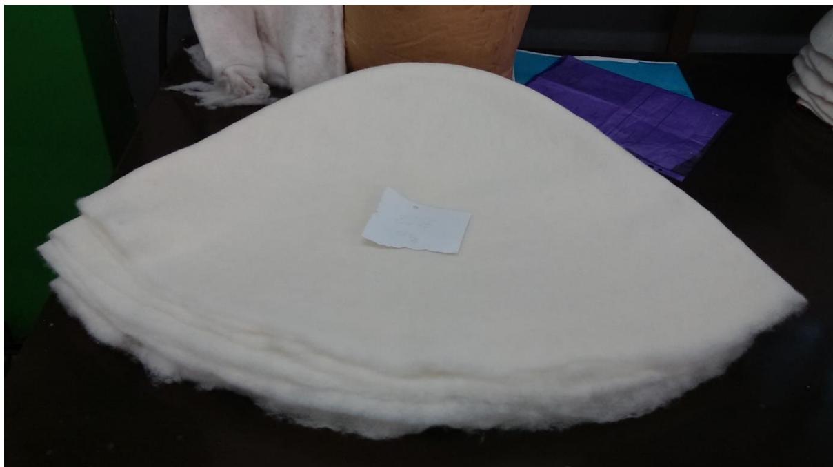
Obrázek 1: Polotovar klobouku před valchováním
