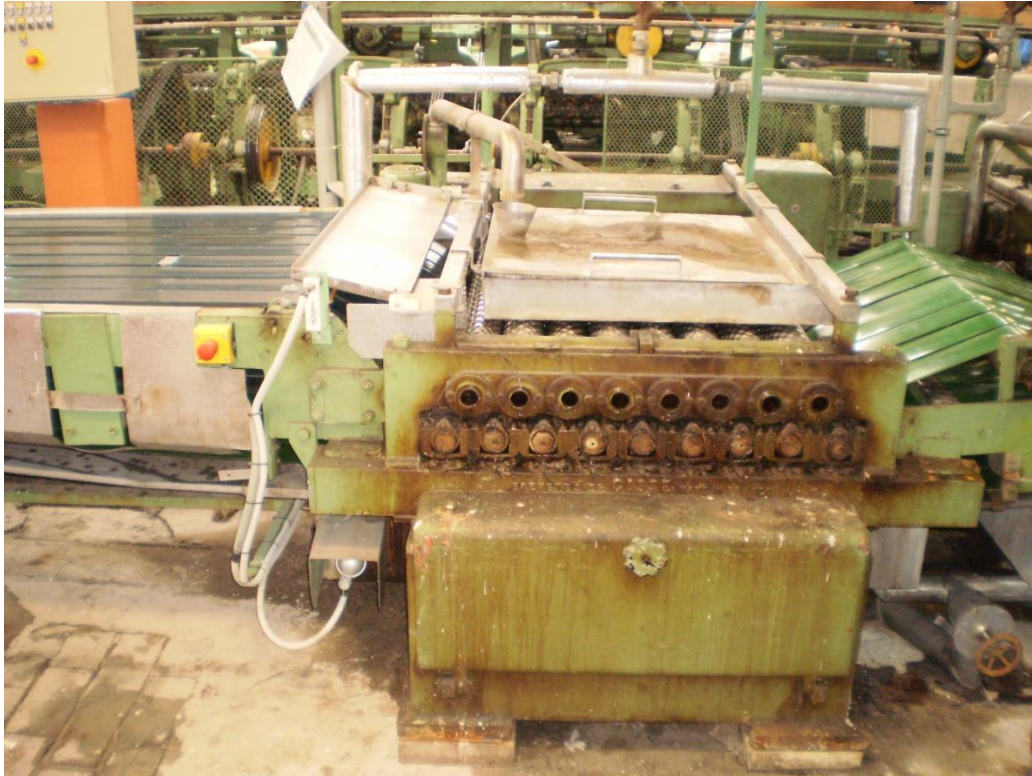
Obrázek 2: Valchovací stroj, polotovar se pohybuje zleva doprava
