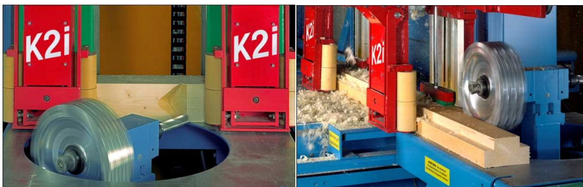
Obrázek 11 Univerzální frézovací agregát - 4osý
