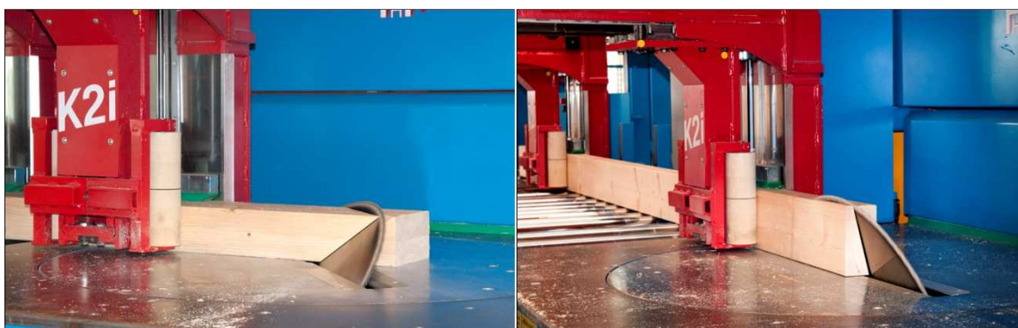
Obrázek 10 Podstolová otáčecí kapovací pila
