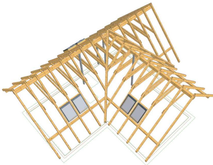
Obrázek 49 Krov nakreslen v konstrukčním programu
