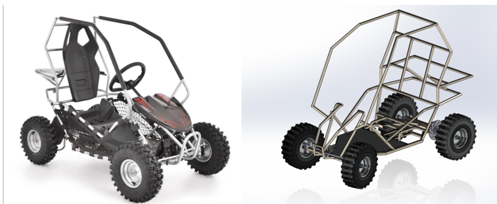
Obrázek 6.3: V levé části originální stav a v pravé části po odstrojení
