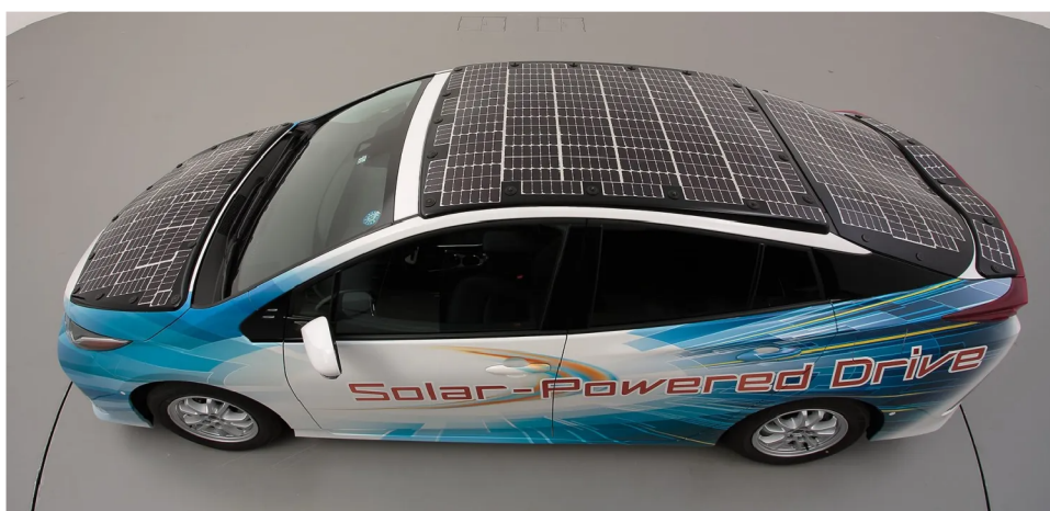
Obrázek 5.18: Solární panely na vozidle značky Toyota (Zilvar, 2020)
