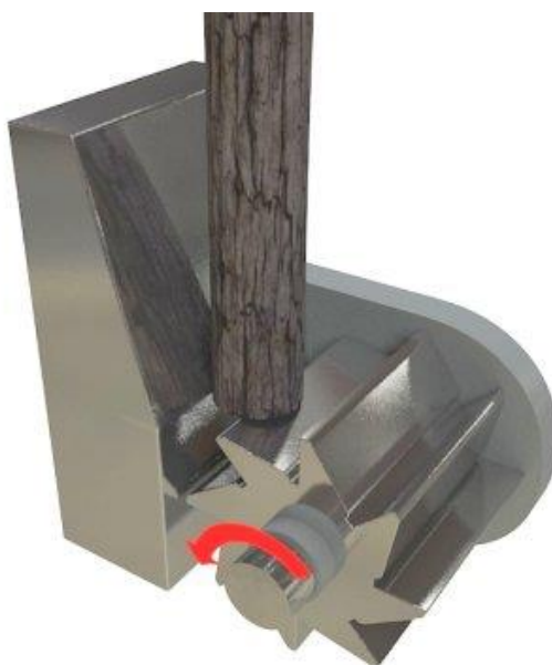
Obr. 4 Způsob drcení se zubovou hlavou [4]
