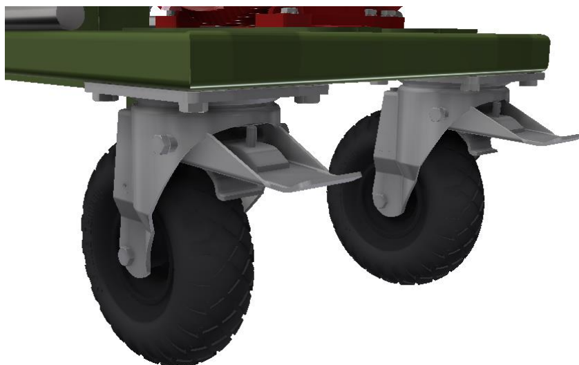
Obr. 33 Přední kolečka přišroubovaná k rámu stroje
