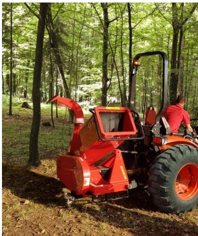
Obr. 12 Drtič dřeva s pohonem na hřídel GTM GTS 1300 PTO [26]
