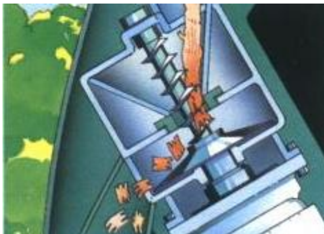
Obr. 6 Šnekový drtící mechanismus [18]
